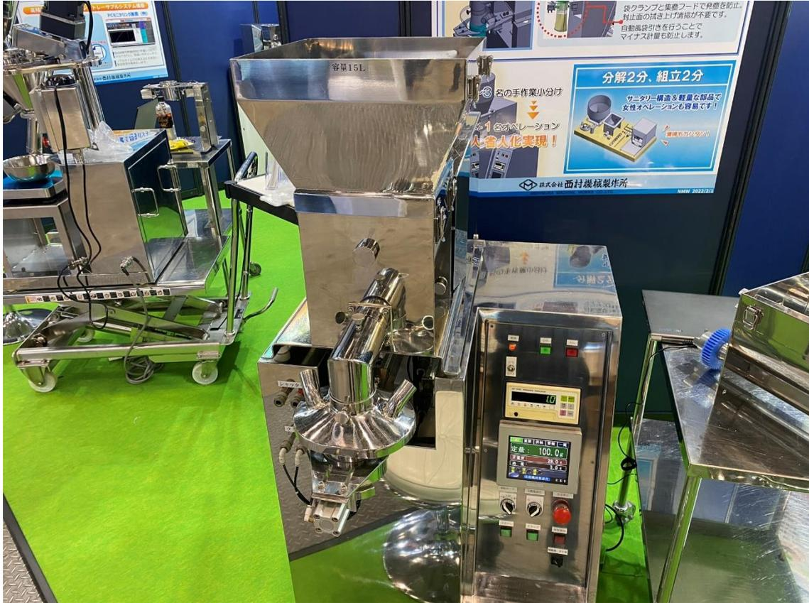
ロードセルや台秤を使用し、独自の2軸一体型スクリーフィーダーを用いて高精度の計量充填が可能です。
